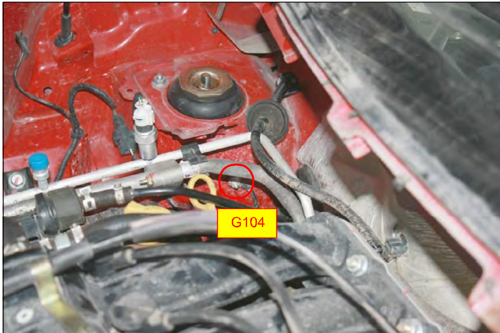
前舱线束搭铁点G104实车位置图(右前减震器左侧)
