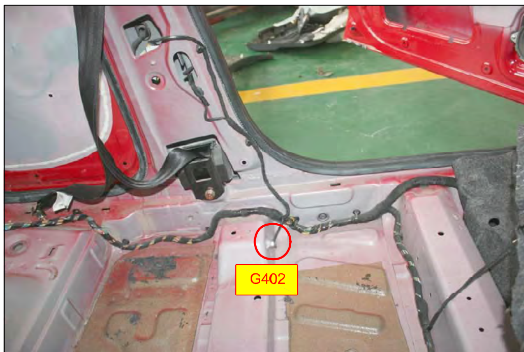
室内线束搭铁点G402实车位置图(左前座椅下方)
