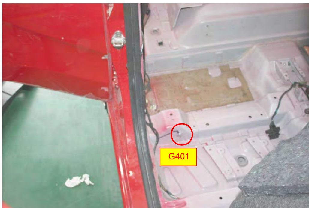
室内线束搭铁点G401实车位置图(右前座椅下方)
