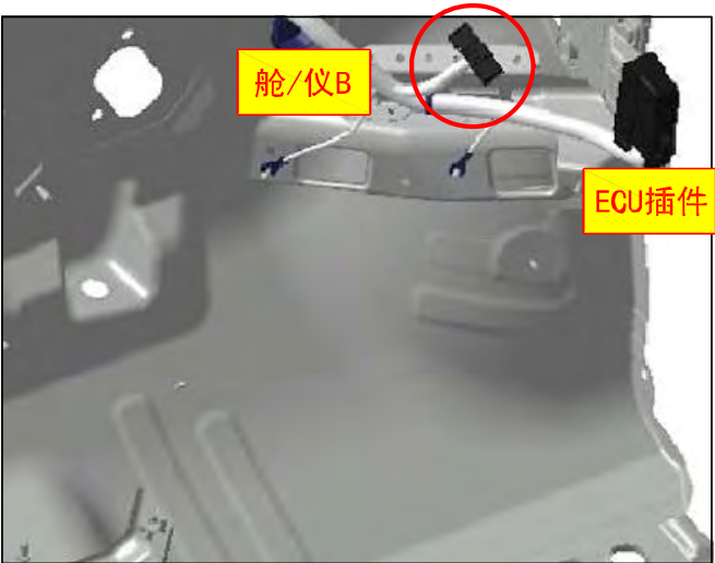
舱/仪B插接器实车位置图（仪表台总成右侧）
