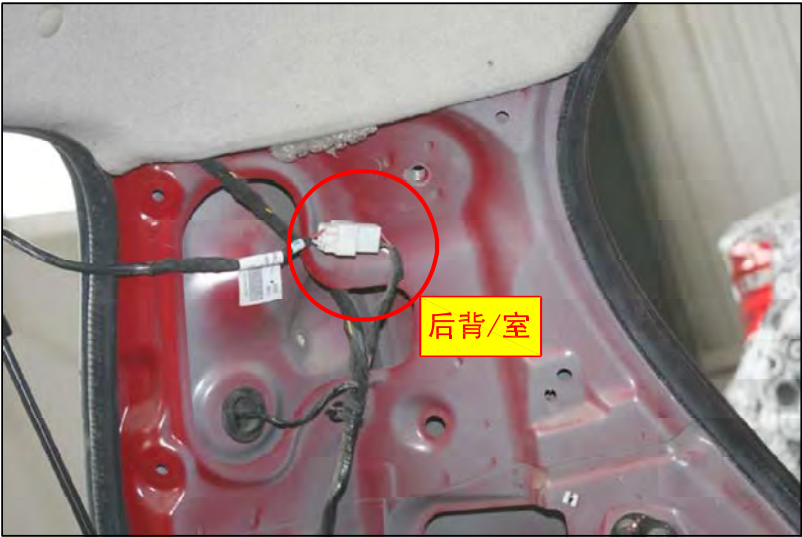
后背/室插接器实车位置图（后背门左侧）
