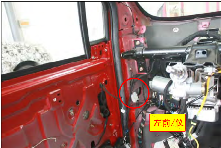
左前/仪插接器实车位置图（左前门A柱内侧）
