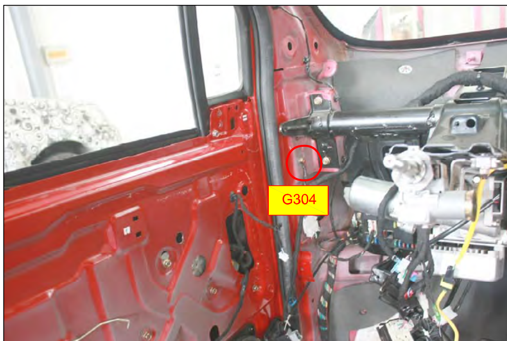
仪表线束搭铁点G304实车位置图(左前A柱下方)
