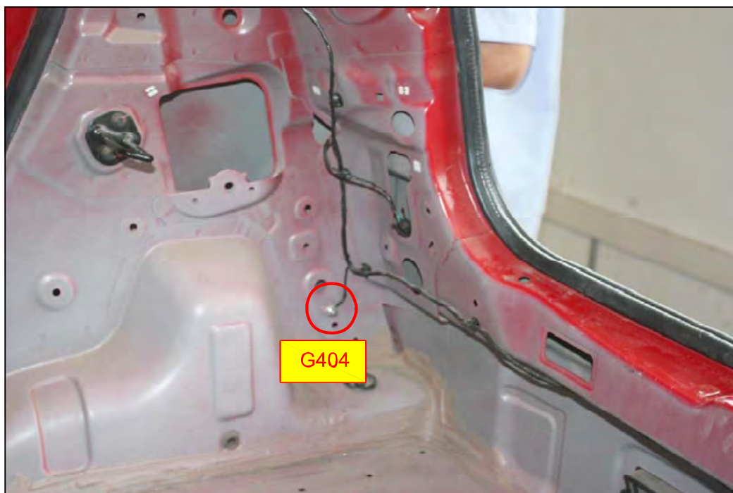
室内线束搭铁点G404实车位置图(右后尾灯后方)
